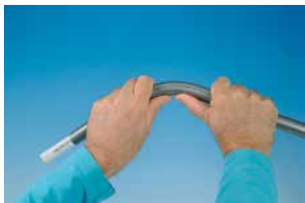
Гибка с помощью внешней гибочной пружины
